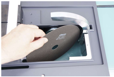
砥石交換（専用バイス装着時）
