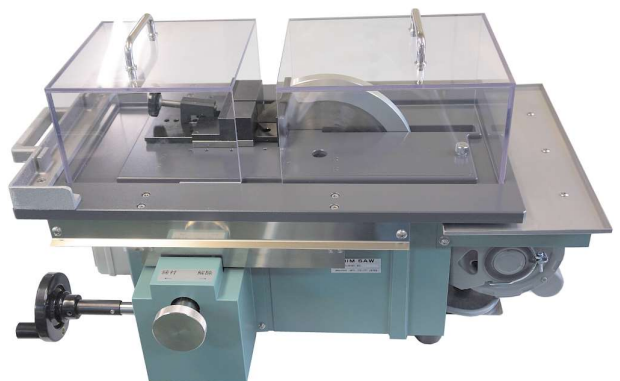
長尺試料加工時の前後カバー
